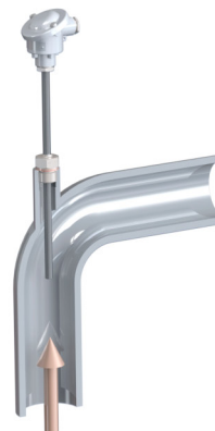
v koleně potrubí
