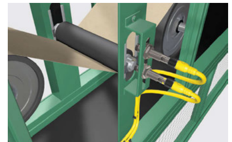
Napnutí papíru – pár snímačů 872C detekuje pozici napínací kladky pro řízení rychlosti
