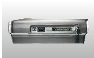
Boční připojení mini-USB kabelu a SD karty
