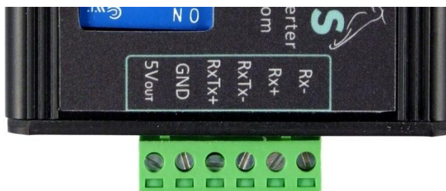
obr. 2 – svorkovnice na SB485S
