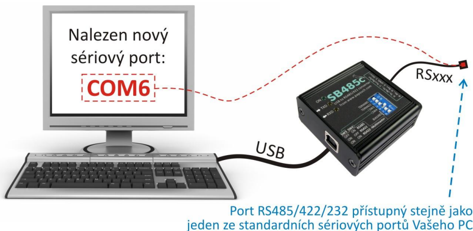
obr. 1 – Po připojení se na Vašem PC vytvoří tzv. „virtuální sériový port“. V systému se chová jako další standardní sériový port COM.
