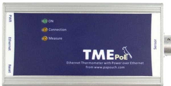
obr. 7 – Varianta s napájením přes Ethernet – tzv. PoE („TME PoE“)
