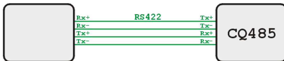
obr. 13 - Příklad zapojení systému propojeného linkou RS422. Oba moduly mají připojeno zakončení.
