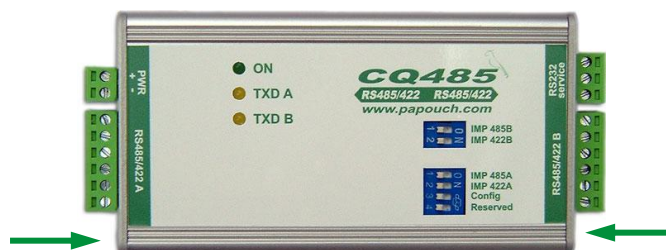
obr. 10 - Umístění šroubů upevňujících víčko krabičky
