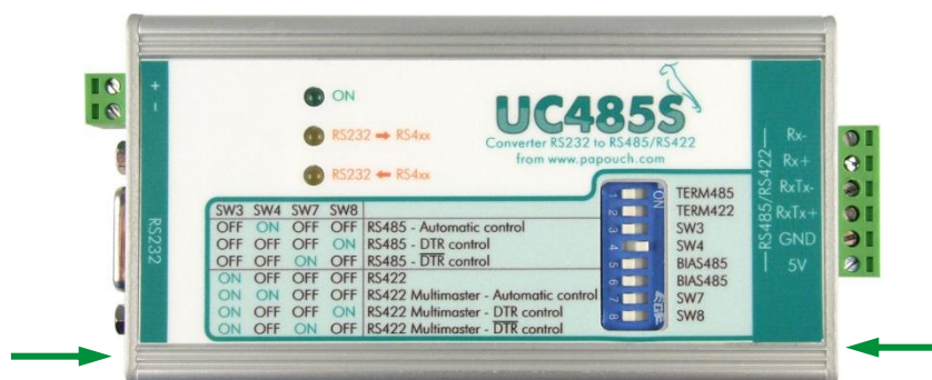
Obr. 14 – Umístění šroubů upevňujících víčko krabičky
