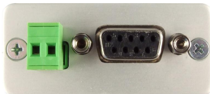
obr. 6 – Konektory napájení a sériové linky RS232
