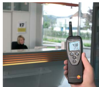
testo 625 s vlhkosní sondou při kontrole ovzduší v místnosti
