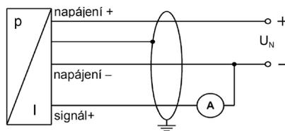
**Třívodičové připojení (napětí):**
